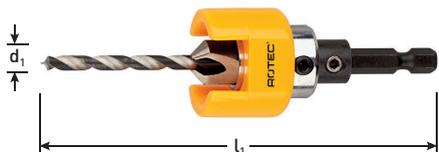
**Ausführung:** Die Holzspiralbohrer und Senker sind geschliffen und aus HSS Werkzeugstahl. Mit 1/4" 6-knt. Bitschaft und in einem Stück gefertigt (nicht geklebt und nicht gelötet) und ist weiteres speziell gehärtet, um größeren Beanspruchungen von z.B. rotierend schlagenden Akkuschraubern standzuhalten.
