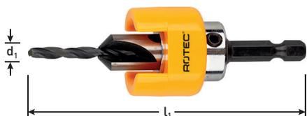
**Ausführung:** Die Metallschraubbohrer und Senker sind geschliffen und aus HSS Werkzeugstahl. Mit 1/4" 6-knt. Bitschaft und in einem Stück gefertigt (nicht geklebt und nicht gelötet) und ist weiteres speziell gehärtet, um größeren Beanspruchungen von z.B. rotierend schlagenden Akkuschraubern standzuhalten.
