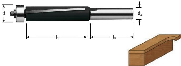
**Ausführung:** Durch den negativen Achswinkel der HW-Platten entsteht ein ziehender Schnitt. Dadurch entsteht ein sehr sauberes Ergebnis an der Schnittkante. Vorteil bei beschichteten Platten und Kunststoffen aber auch bei langfaserigen Hölzern (Stirnholzbearbeitung). Auch geeignet für die Verwendung mit Schablonen.
