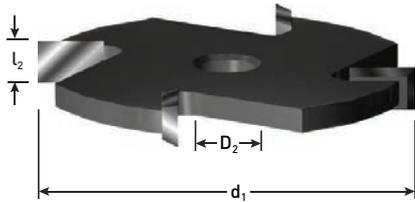
**Ausführung:** Drei gerade Schneiden, umfang- und flankenschneidend. Einsatz auf Maschinen mit ø8mm Spindel bzw. Fräsdornen mit Aufnahme 8mm [271.42.0800 und 272.42.0800] ohne Anlaufring oder Fräsdornen [271.44.0800 und 272.44.0800] mit Anlaufring.
