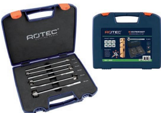
**Ausführung:** 3D-Forstnerbohrer aus hochwertigem SP-Stahl (Spezialstahl). Der geschliffene 3-Flächenschaft verhindert das Durchrutschen im Bohrfutter. Die scharf geschliffenen Schneiden und der im Durchmesser reduzierte Hals ermöglichen den Einsatz des Bohrers in jeder Richtung.
