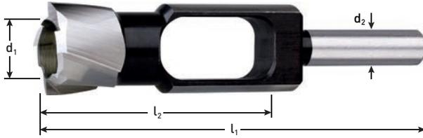
**Ausführung:** Zapfenschneider nach DIN 7489, mehrschneidig, mit Peripherieschneide und zylindrischem Schaft. HS- und HW-Ausführung sowie Spezialschäfte wie MK und Innengewinde auf Anfrage.
