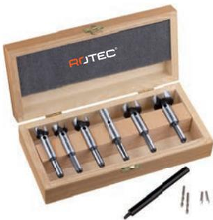
**Ausführung:** Ähnlich DIN 7483G, mit austauschbarer Zentrierspitze und Zentrierbohrer, Peripherieschneide mit patentiertem Wellenschliff, 2 Schneiden und einem Kegelschaft mit 3 Flächen.
