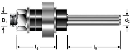
**Anwendung:** Aufnahme mit Anlaufring für HM-Scheibenfräser 271.43 und 271.41
