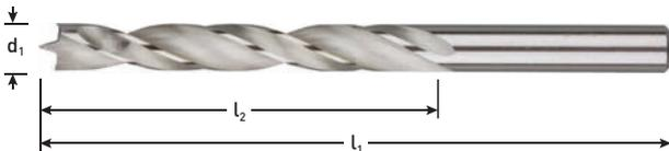
**Ausführung:** Holzspiralbohrer mit Zentrierspitze, 2 Schneidern und 2 Vorschneidern in gezogener Ausführung sorgen für das Niederziehen und Durchtrennen der Holzfasern, bevor das Loch gebohrt wird. Die 4 Führungsfasen verhindern das Abweichen des Durchmessers.
